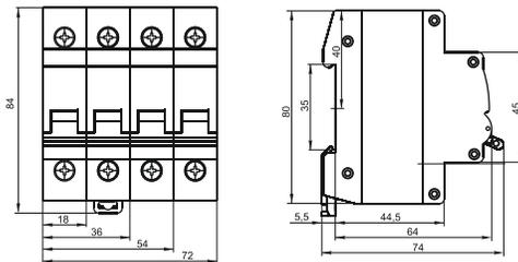
Рисунок 1 – Габаритные и установочные размеры ВА 47-63
