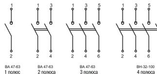
Рисунок 2 – Схемы электрические ВА 47-63
